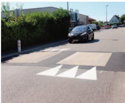
Un nouvel aménagement de sécurité routière a été réalisé au mois de mars pour remplacer l'ancienne chicane. Deux paires de coussins dits « lyonnais » (ralentisseurs béton et scellés au sol) ont été installés à deux endroits distincts pour créer deux points de ralentissement dans la rue.
